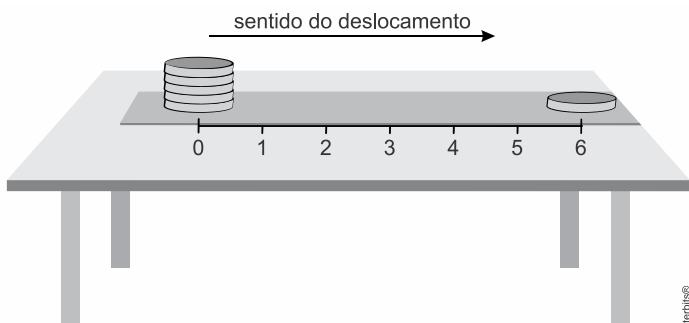
Ao se deslocar a régua da esquerda para a direita, o sistema permanecerá em equilíbrio na horizontal até que determinado ponto da régua atinja a extremidade da mesa.
