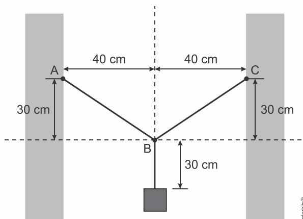
Sabendo que o sistema está em equilíbrio estático, determine o valor, em N, da tração que existe no pedaço  $\overline{AB}$  do fio ideal preso à parede. Adote o módulo da aceleração da gravidade no local igual a  $10 \text{ m/s}^2$ .
